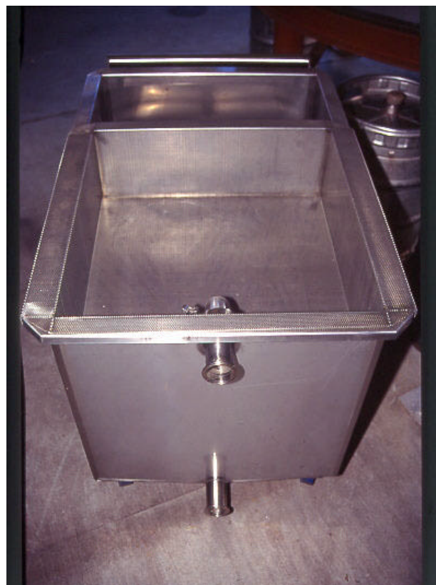
Abbildung 1 Praxisgerechte Lösungen zum Eintrag von Sauerstoff: links oben gasdurchlässiges Sintermetall ; rechts Siebwagen zur Kernabtrennung und Sauerstoffaufnahme vor der Pumpe, links unten Saftabzug bei Überschwallen oberhalb des Kerndepots )
